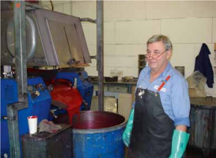
Abbildung 10: Beispiel für eine Walzenstuhl-Absaugung
