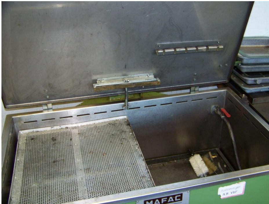
Abbildung 4: Beispiel für einen Teilewaschtisch mit Randabsaugung
