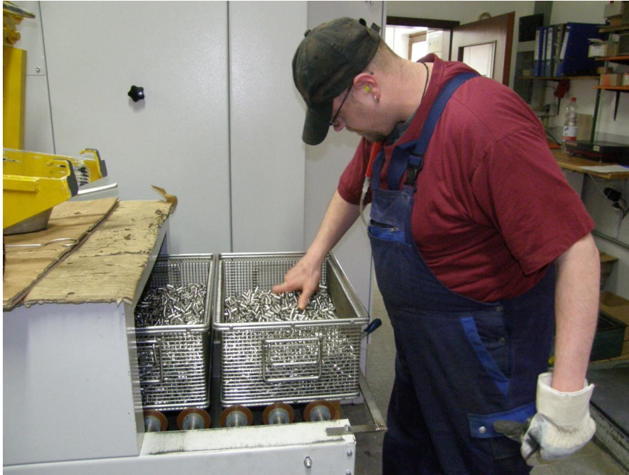
Abbildung 3: Einkammeranlage; Kontrolle gereinigter Teile (RP Kassel)
